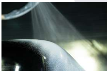
02. Aplicación de la primera capa base de nuestro exclusivo Gelcoat
